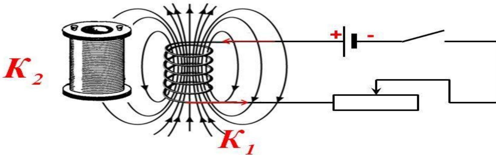
Магнитный поток, пронизывающий катушку  $K_2$  можно менять путем изменения взаимной ориентации катушек и изменением силы тока реостатом  $R$  или замыканием – размыканием ключа  $K$ .
