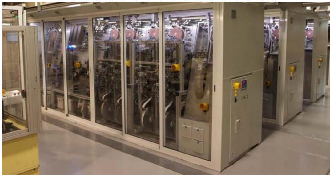
Рисунок 1 – Фотография инспекционно-сортировального канала машины БИСМ
