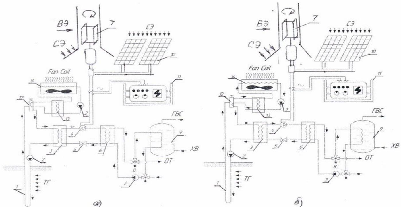
**Схема использования КВСВЭУ с пассивной системой охлаждения совместно с ТНУ и ФЭП**
