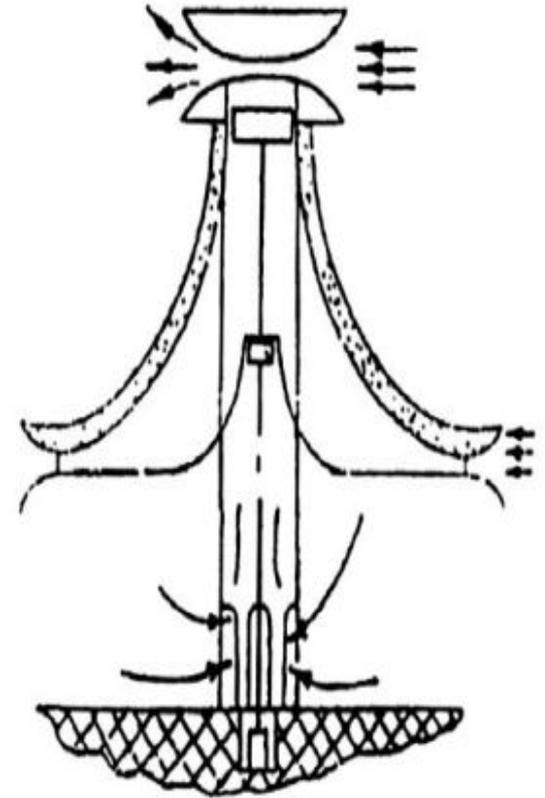
**Вихревая ветроэнергостанция** фирмы **Gumman Aerospace Corporation** для генерирования вихрей используется башня, установленная над осевыми ветроколесами в кольцах. Для типовых систем диаметр башни может быть в 3 раза больше диаметра ветроколеса, а высота башни – в 3 раза превышать ее диаметр или быть в 9 раз больше диаметра ветроколеса
