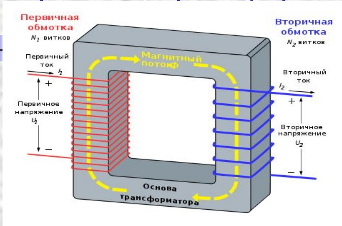
**Замкнутый стальной сердечник, состоящий из отдельных пластин**
