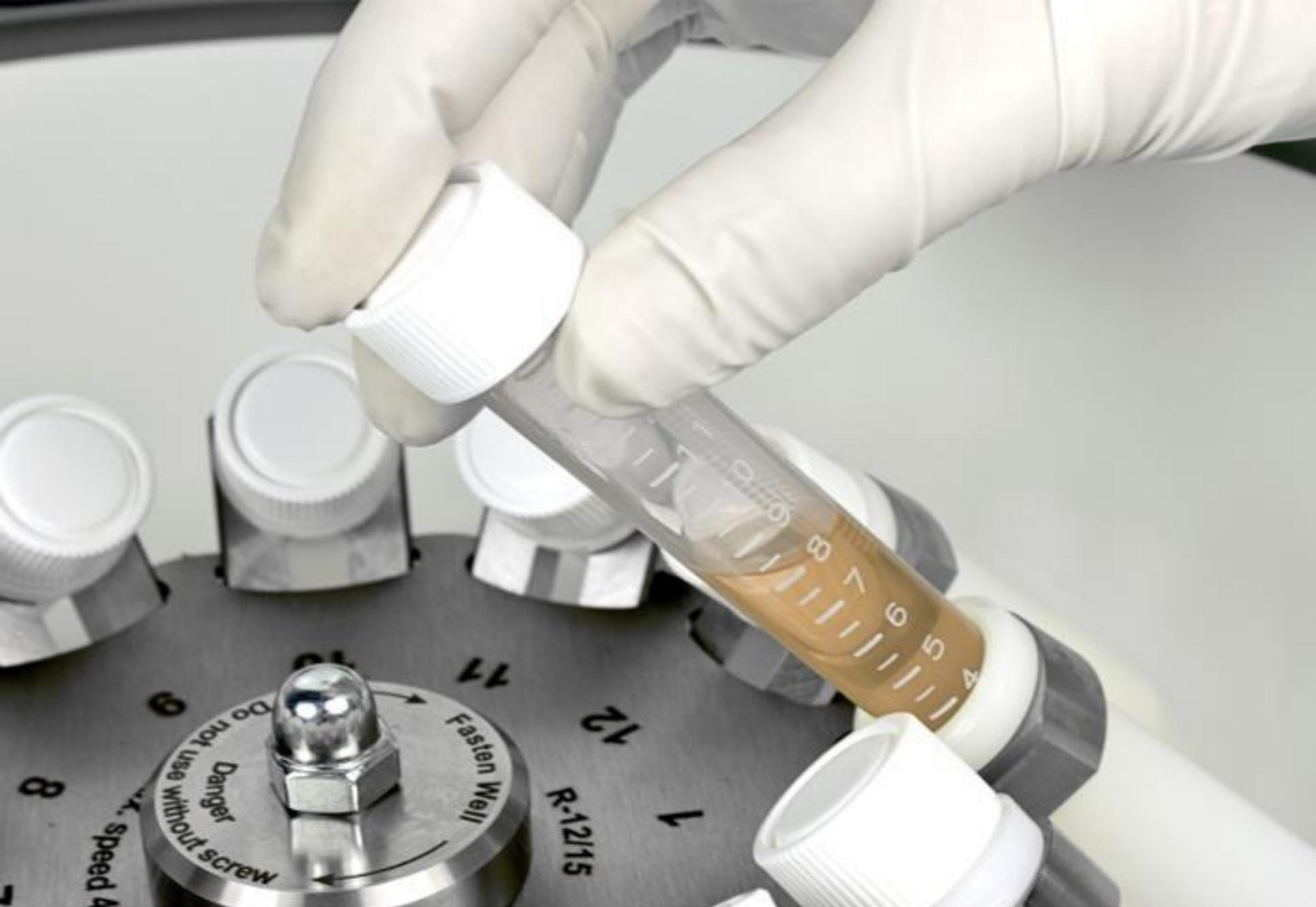
Жидкость центрифугируют 20-30 минут при 3000-3500 об/мин.
