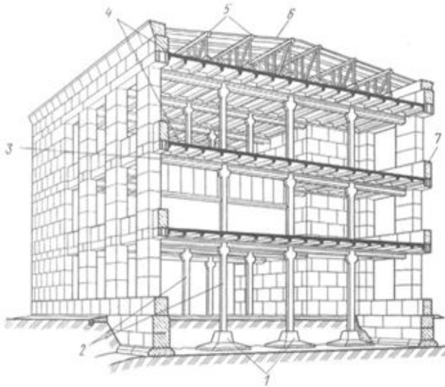
Конструктивной основой многоэтажного здания служит пространственная несущая система из стержневых и панельных железобетонных элементов, взаимосвязанных между собой в порядке, обеспечивающем прочность, устойчивость и долговечность системы в целом, а также ее отдельных элементов.
