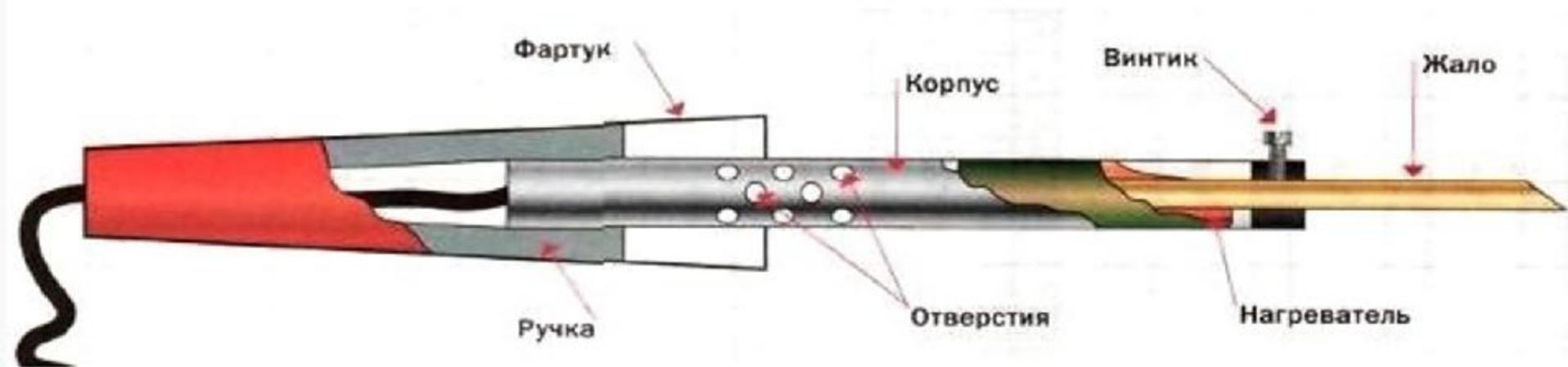
Стержневой конец паяльника, представляет собой рабочую часть инструмента с клиновидной формой на конце. Это и называют жалом паяльного прибора.
