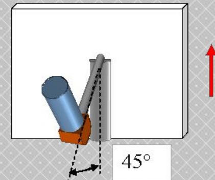
3. Наплавить валик на вертикальной поверхности с колебательными движениями электродом.
