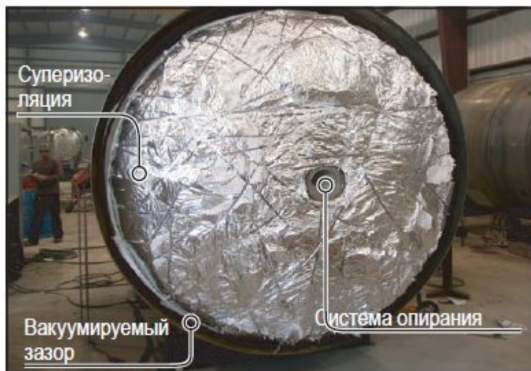
Конструкция емкости с суперизоляцией
