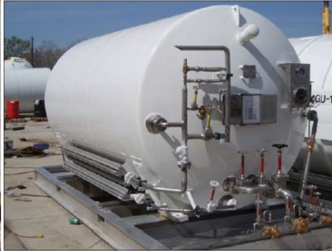
Емкость, смонтированная на салазках
