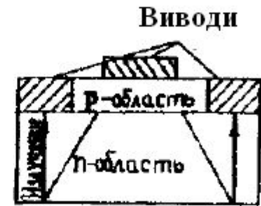
Рисунок 2- Схематичний пристрій півсферичного і плоского світлодіодів
