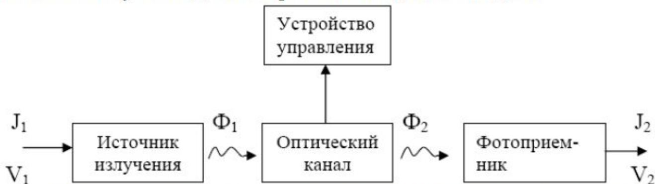
Рисунок 1 -Схема оптрона з електричним входом і виходом
