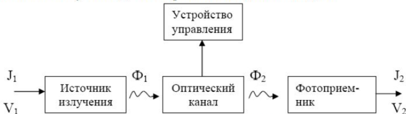
Рисунок 1 -Схема оптрона з електричним входом і виходом
