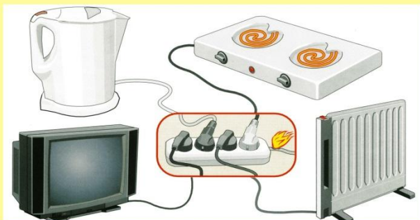
Неисправная электропроводка, электроизоляция, перегрузка электросети.
