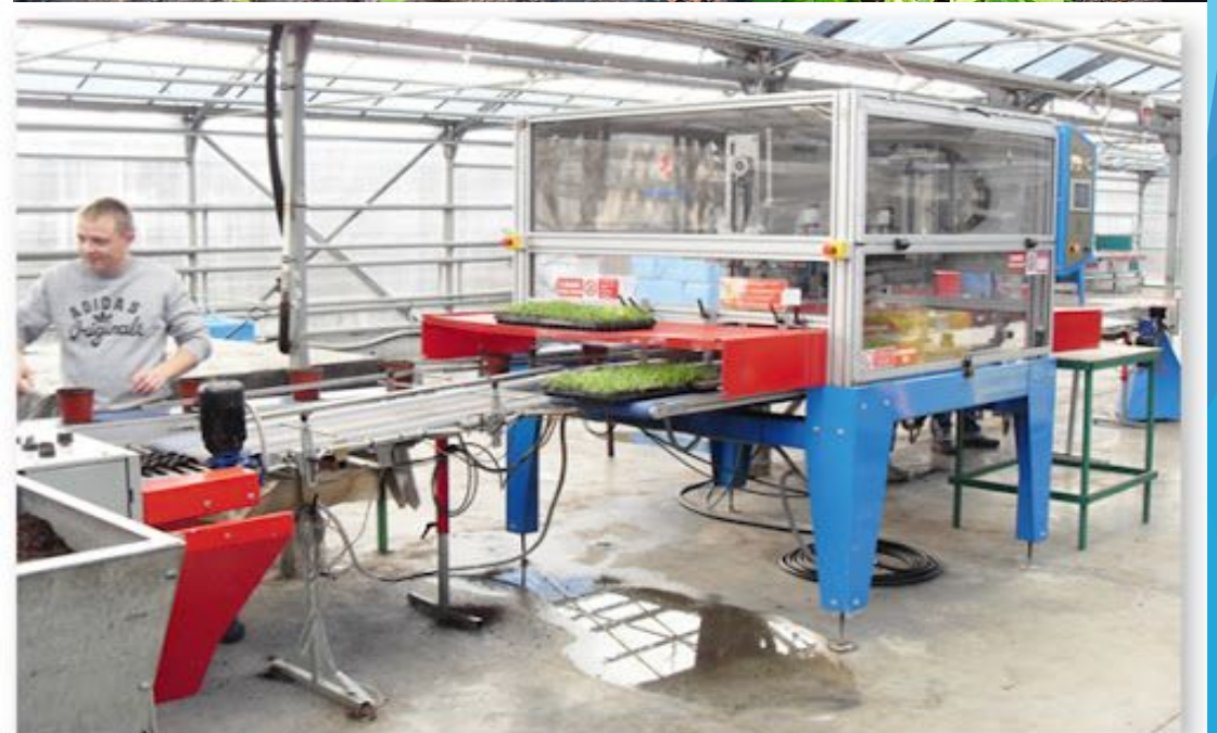
Пересадочный комплекс, Егорьевский тепличный комбинат
