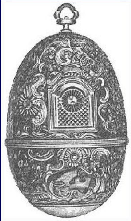
В часы размером с гусиное яйцо (427 деталей) был установлен механизм часового боя, музыкальный аппарат, воспроизводящий несколько мелодий, и миниатюрный механизм, приводивший в действие фигурки в столь же крошечном встроенном театре.
