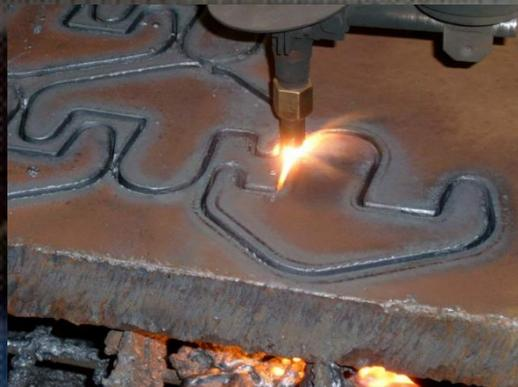
Используемые для получения плазменной струи газы делятся на активные (кислород, воздух) и неактивные (азот, аргон, водород, водяной пар). Активные газы в основном используются для резки чёрных металлов, а неактивные — цветных металлов и сплавов.
