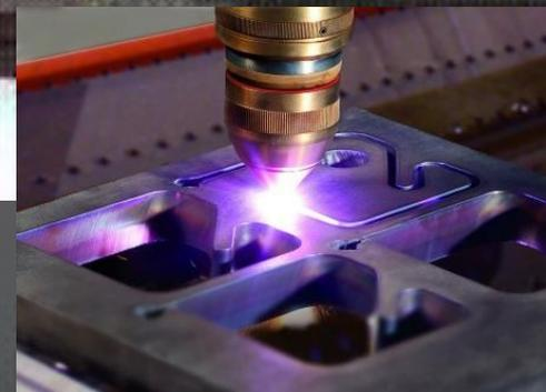
Плазменная резка — вид плазменной обработки материалов, при котором в качестве режущего инструмента вместо резца используется струя плазмы.
