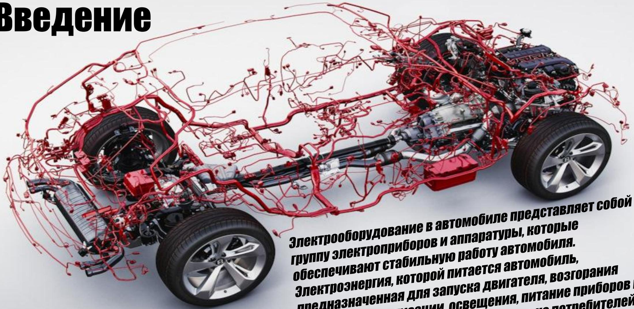
**Электрооборудование в автомобиле представляет собой группу электроприборов и аппаратуры, которые обеспечивают стабильную работу автомобиля. Электроэнергия, которой питается автомобиль, предназначена для запуска двигателя, возгорания горючего, сигнализации, освещения, питания приборов и т. д. Автомобиль включает в себя не только потребителей, но и источник тока.**
