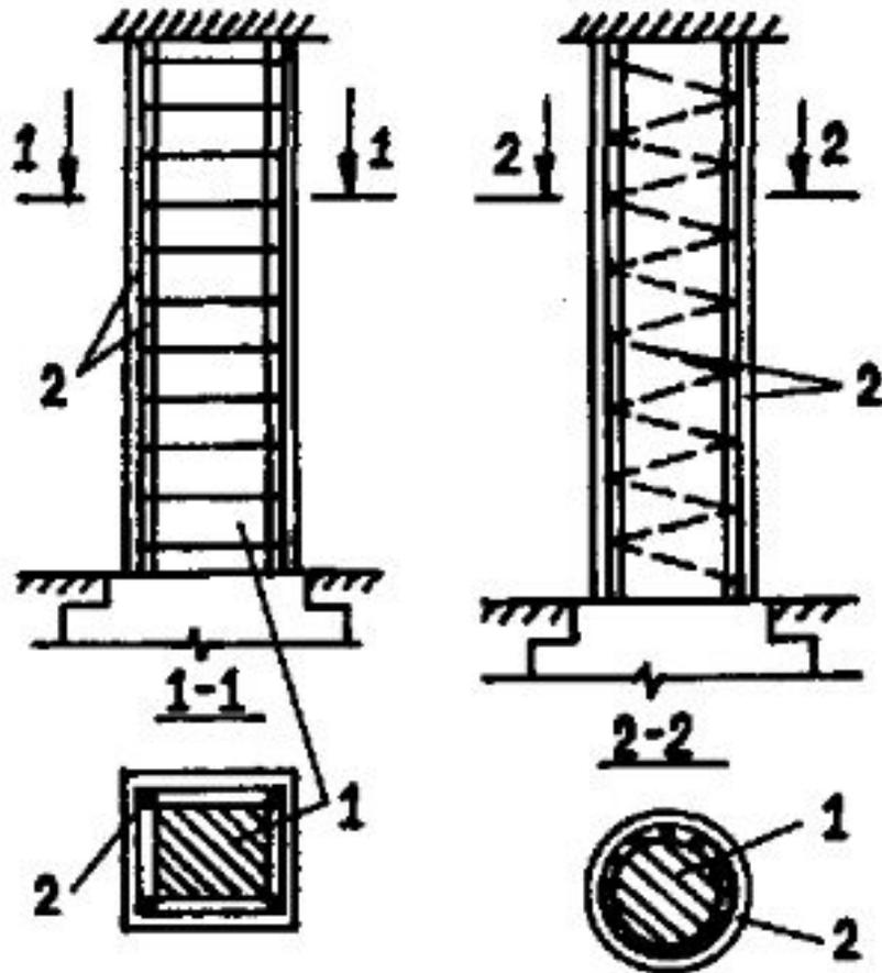
Наращивание — увеличение сечения усиливаемых конструкций сверху, снизу и с боков слоем монолитного железобетона (балка, ригель, колонна, стены, плита перекрытия). Усиление колонн обетонированием выполняется в последовательности:
