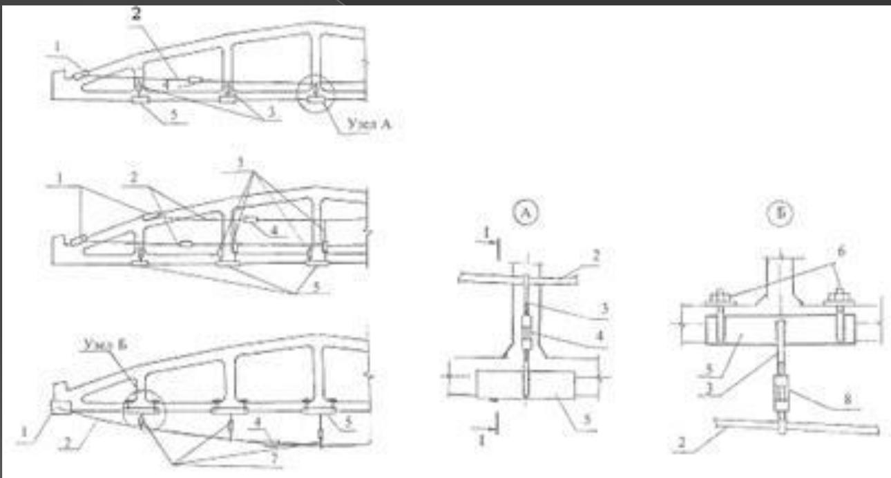
1 – анкерное устройство; 2 – цепи или тросы; 3 – металлические напрягаемые элементы; 4 – тельферные напрягающие устройства; 5 – анкерные крепления; 6 – напрягающие устройства домкратного типа; 7 – напрягающая подвеска с распорной муфтой; 8 – распорная муфта
