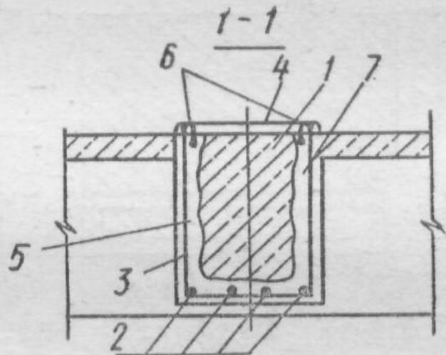
Распространенным способом усиления изгибаемых железобетонных элементов является устройство «рубашек» — незамкнутых с одной стороны обетонков. Этот способ рекомендуется при усилении балок ребристых перекрытий и т.п.
