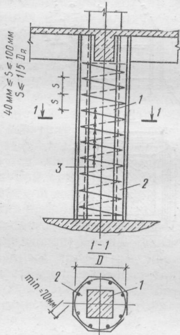
Поперечная арматура железобетонной обоймы может быть выполнена в виде спиральной обмотки из проволоки диаметром не менее 6 мм. При этом спирали в плане должны быть круглыми и охватывать всю рабочую продольную арматуру. Расстояние между ветвями спирали должно быть не менее 40 мм и не более 100 мм, оно не должно также превышать 0,2 диаметра сечения ядра обоймы, охваченного спиралью.
