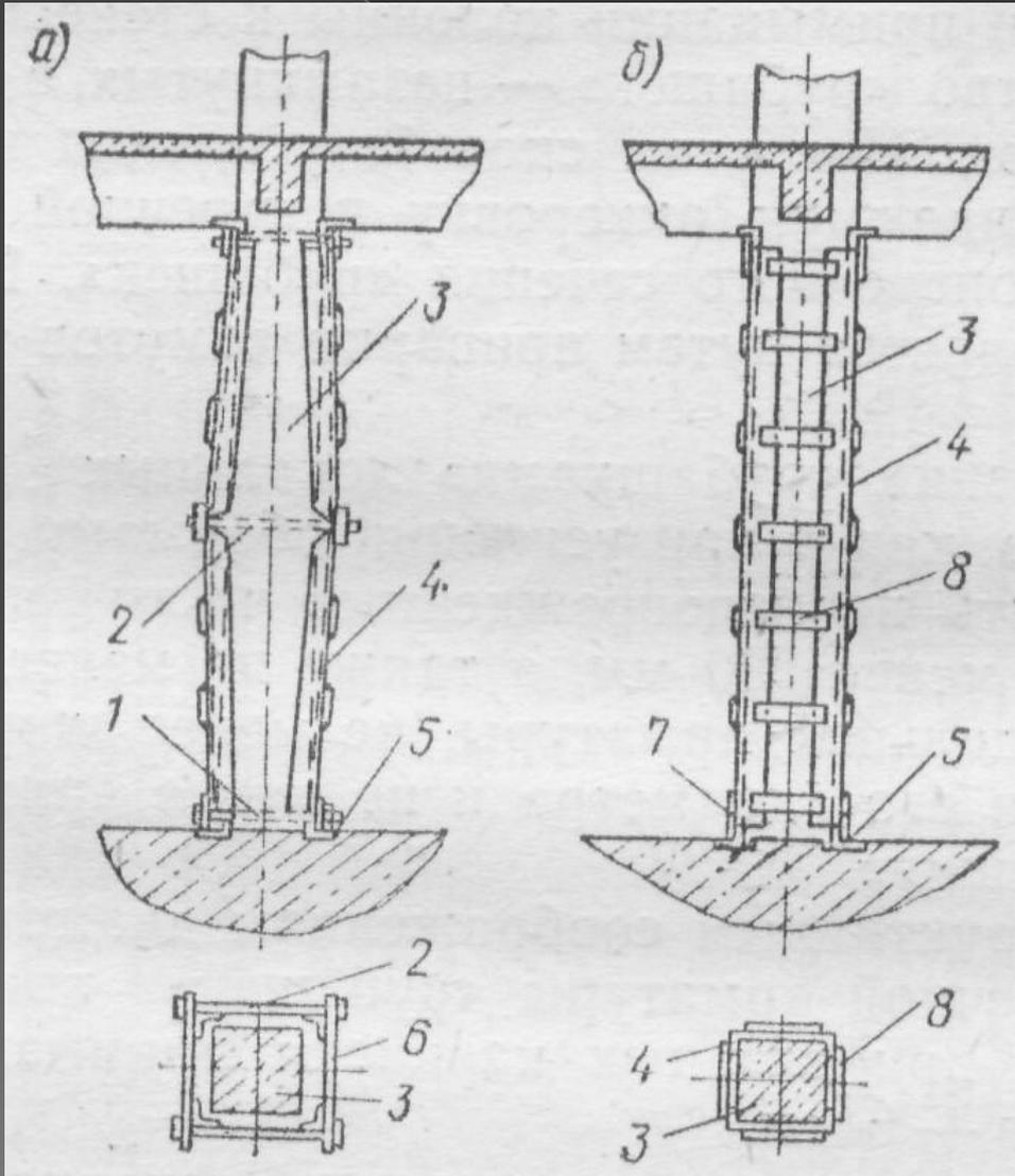
Предварительно напряженные односторонние распорки состоят из двух уголков, соединенных между собой металлическими планками. В верхней и нижней зонах распорок приваривают специальные планки толщиной не менее 15 мм, которые передают нагрузку на упорные уголки и имеют площадь поперечного сечения, равную сечению распорок.
