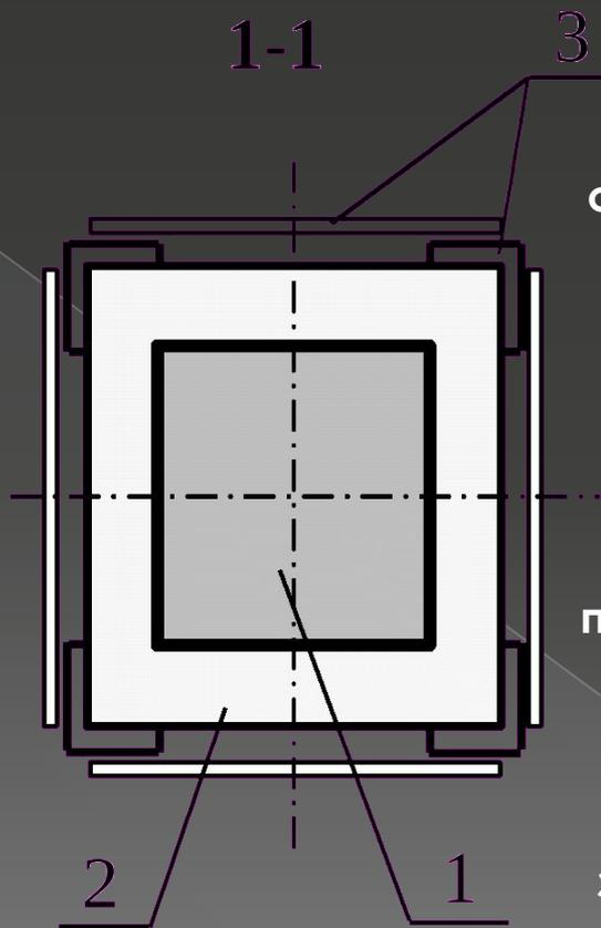
1 – усиленная колонна; 2 – бетонная обойма; 3 – металлическая обойма.
