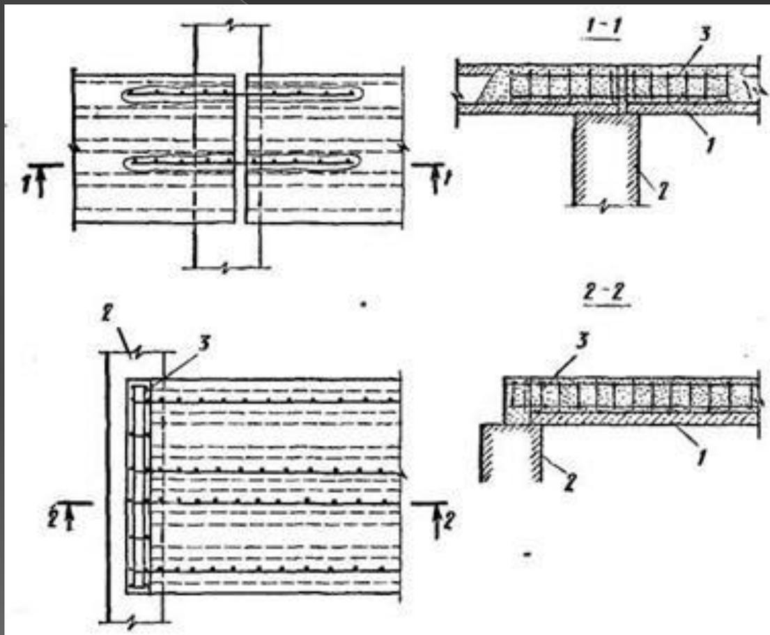
Усиление опорных частей пустотных плит при недостаточной площади их опирания рекомендуется осуществлять по следующим схемам: для крайних опор путем установки в каналах арматурных каркасов с выносом их за торцы плит на требуемую длину, последующей установкой вертикальных каркасов параллельно торцам плит, бетонированием анкерной балки и опорных участков пустот плиты.
