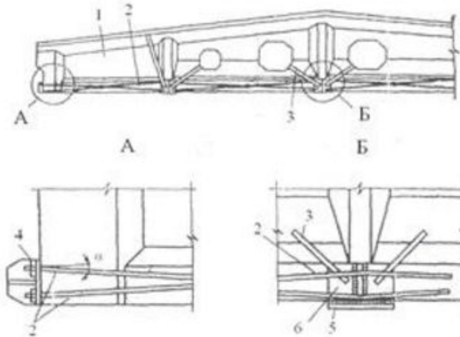
Опорный узел представляет собой сварную конструкцию из пластинчатой стали с ребрами жесткости, в которой имеются отверстия для пропуска тяжей из круглой стали (узел А). Узел в пролете балки (узел Б) состоит из горизонтальной пластины опорного хомута и двух вертикальных пластин, которые поддерживаются монтажными хомутами. Натяжение горизонтальных тяжей осуществляют одновременно с двух противоположных сторон балок электрофицированными тарированными гайковертами либо электротермическим способом.
