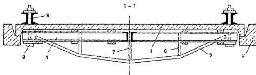
Если невозможно выполнить набетонку для усиления плит, опертых по контуру, рекомендуется подвести под плиты предварительно напряженный пространственный шпренгель, который состоит из двух взаимно пересекающихся в одном уровне плоских шпренгелей, верхние пояса которых плотно подгоняются под нижнюю плоскость плиты, а нижние пояса предварительно напрягаются механическим или термомеханическим способом.
