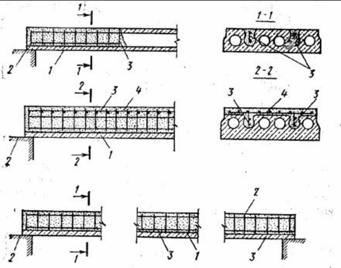
Сборные железобетонные пустотные плиты могут усиливаться с использованием пустот. Для этого сверху в зоне расположения канала пробивают полку и уста навливают арматурный каркас. При усилении только опорной части плиты каркасы располагаются на части ее пролета, а при необходимости усиления по нормальному и наклонному сечениям — по всей длине плиты. После этого канал заполняют пластичным бетоном на мелком щебне и плиту рассчитывают с учетом дополнительной арматуры
