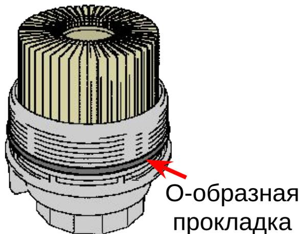
Извлеките фильтрующий элемент и О-образную прокладку из крышки фильтра
