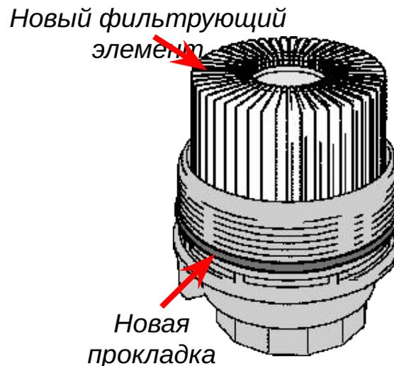
Установите новый фильтрующий элемент и новую О-образную прокладку в крышку фильтра
