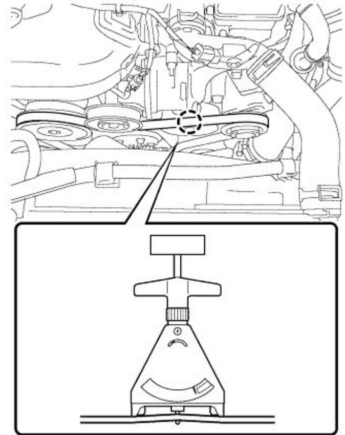
С помощью измерителя натяжения.
