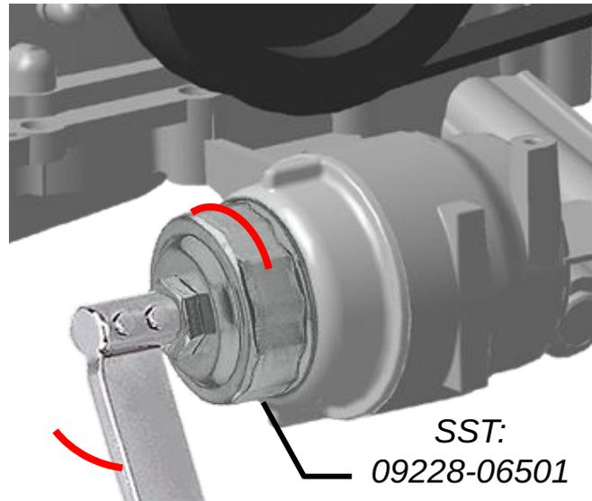
Установите крышку фильтра с помощью специального приспособления (SST)
