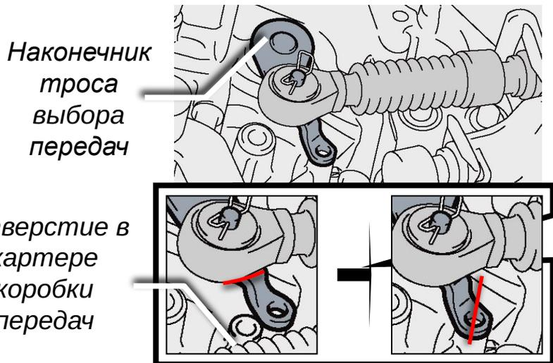
(b) Вставьте болт в совмещенные отверстия
