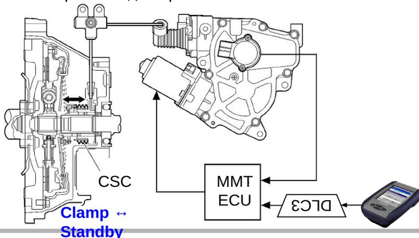
\* MMT – механическая роботизированная коробка передач
