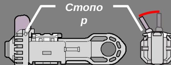
(b) Вытяните фиксирующий элемент
