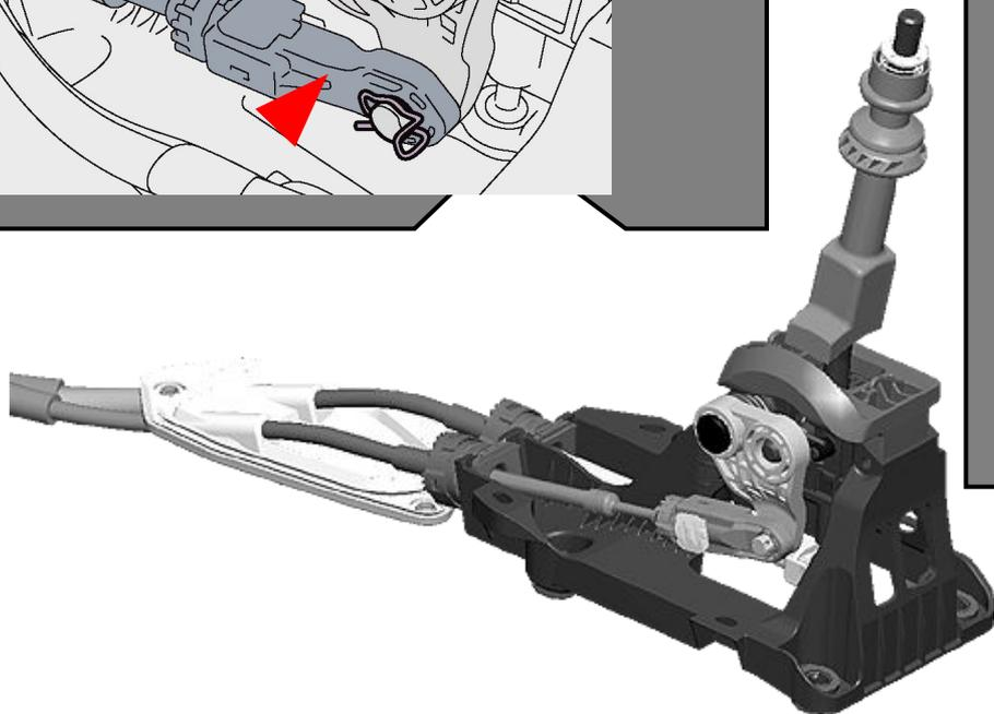
5. Переведите рычаг переключения передач в положение «1-я/2-я передача»
