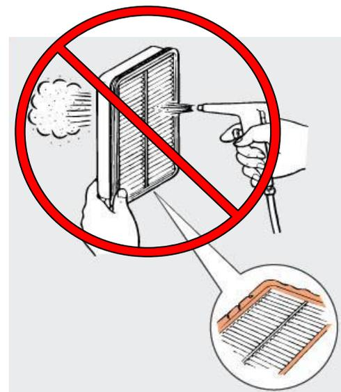
Очищайте фильтр только в случае, когда ремонтный цех оборудован специальной вытяжной системой.
