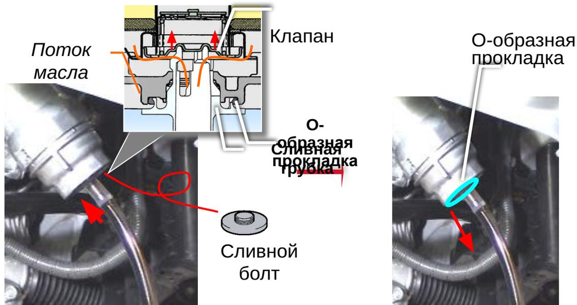
3. Выверните сливной болт и вставьте сливную трубку в отверстие
