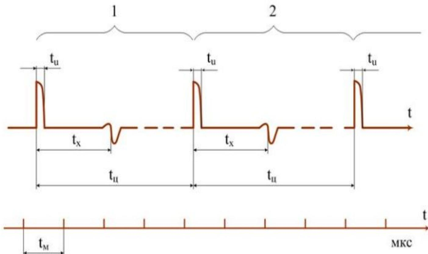
Рисунок. Временная развертка зондирующих отраженных сигналов при импульсном методе определения мест повреждения: 1, 2, ...,  $m$  – единичные процессы, повторяющиеся с частотой 500 - 1000 Гц.
