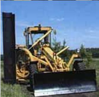
Универсальная подвеска грейдерного оборудования позволяет осуществлять вынос отвала в обе стороны на угол 90°.
