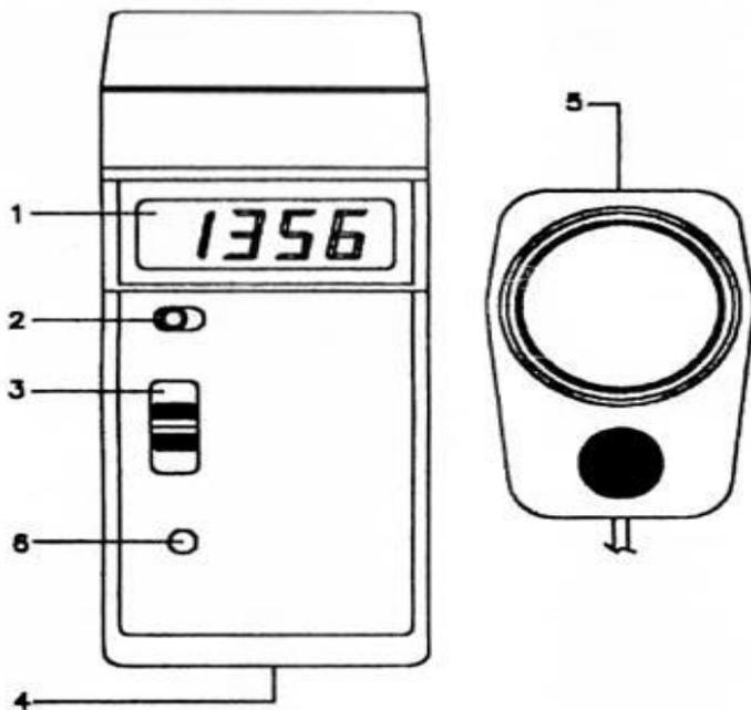
Люксметр – прибор, для измерения освещенности, создаваемой лампами накаливания и естественным светом. Люксметр АТТ -1508 1 –дисплей, 2- кнопка удержания показания, 3- переключатель для выбора диапазона измерений, выключатель прибора, 4- отсек батареи питания, 5 – фотоэлемент (датчик), 6 – потенциометр (установка нуля)
