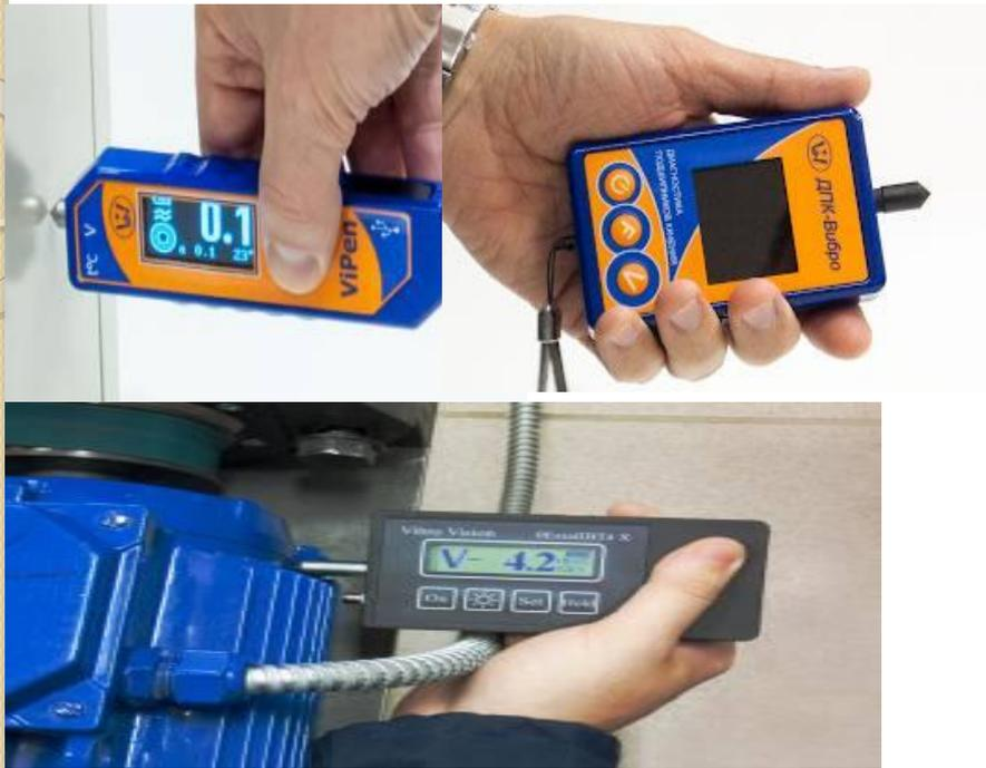
Виброметр – прибор, для измерения параметров вибрации. Виброметры для измерения вибрации вращающегося оборудования, и воздействующей на здоровье человека «виброметры-шумомеры»
