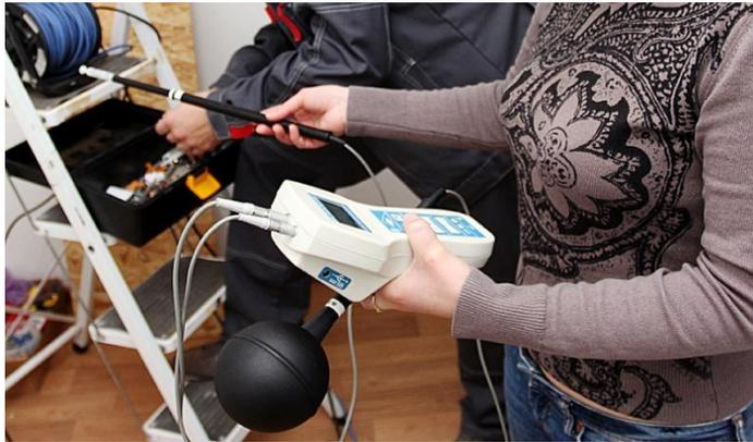
Метеоскоп – прибор, для измерения параметров микроклимата
