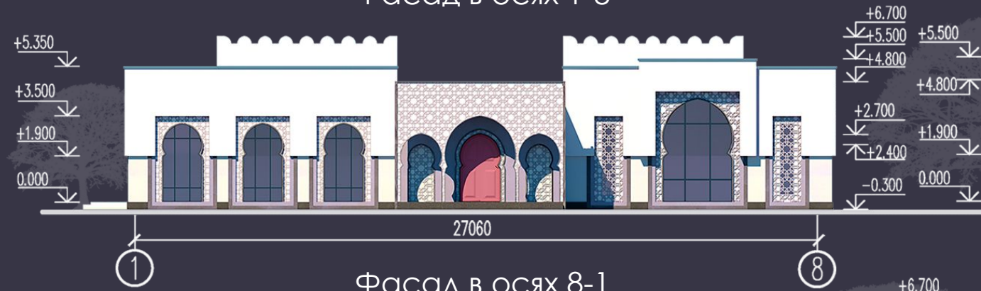
Фасад в осях 1-8
