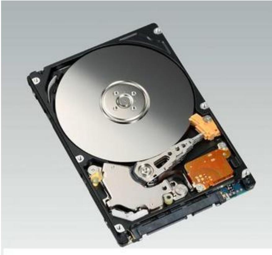
**Шпиндельный двигатель** – это основной потребитель энергии в HDD
