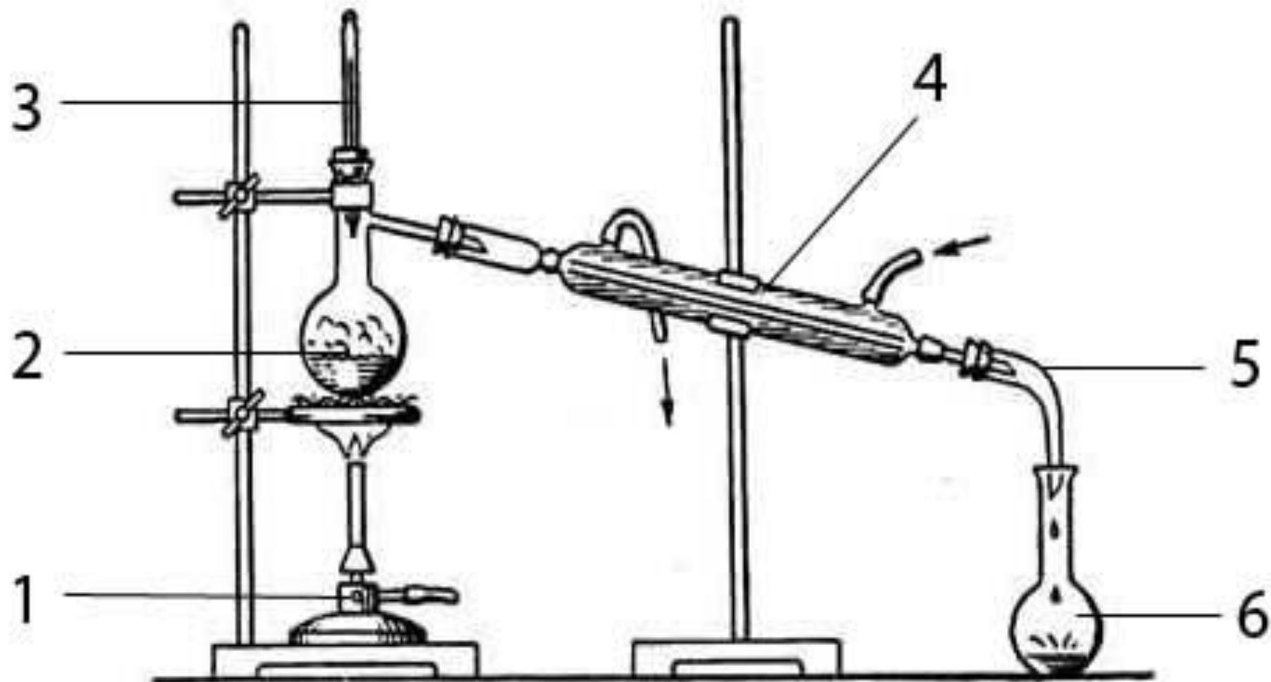
Прибор для перегонки жидкостей
