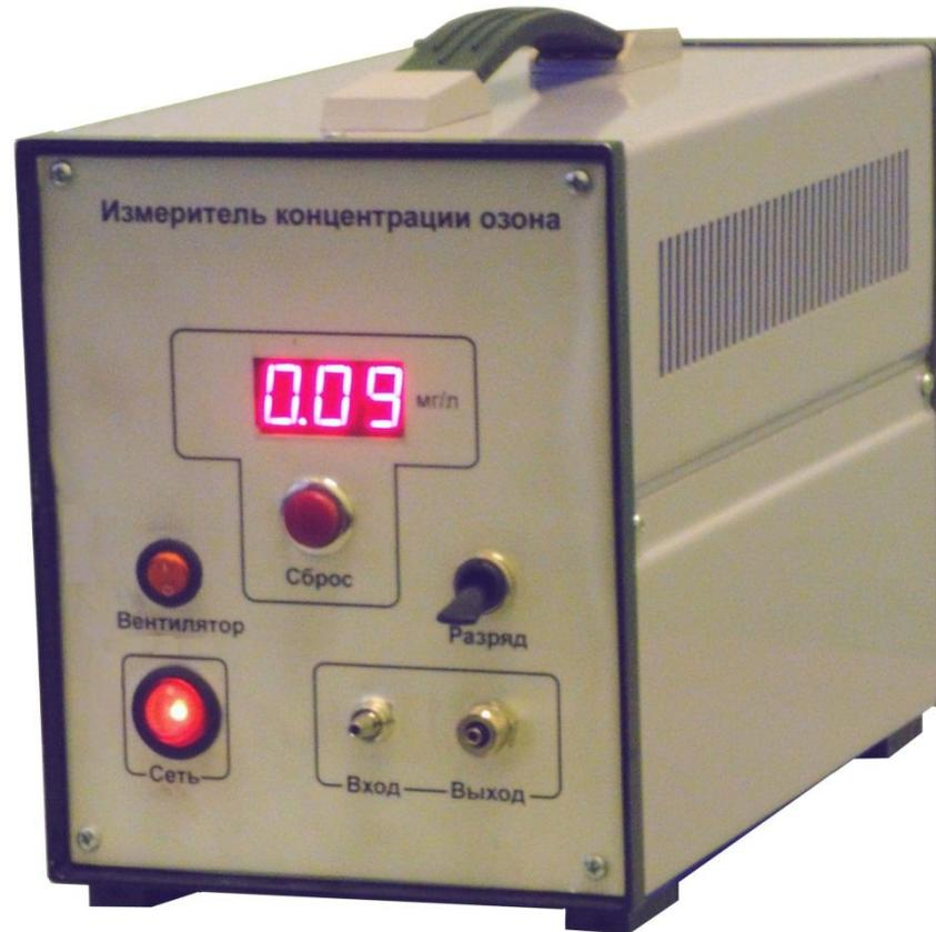
**устройство для измерения концентрации озона на основе спектрально совмещенных оптического излучателя и фотоприемника**
