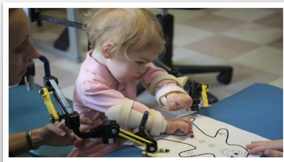
Рисунок 3 - Экзоскелет, напечатанный на 3D принтере для девочки с атрофированными мышцами рук
