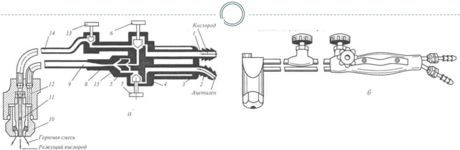
*а* - «Факел», «Маяк-1»; *б*- «Ракета-1»; 1 и 2 - каналы для подвода кислорода и ацетилена; 3 - рукоятка; 4 - корпус; 5 - инжектор; 6, 7 к 13- вентили; 8 - смешительная камера; 9 и 14- трубки; 10 - наружная часть мундштука; 11 - внутренняя часть мундштука; 12 - головка; 15 - накидная гайка
