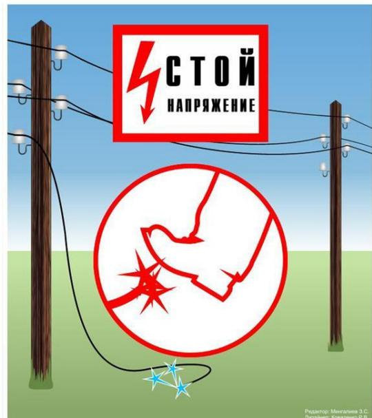
При соприкосновении с оборванными или провисшими проводами, или даже при приближении к лежащему на земле проводу, человек попадает под действие электрического тока и может быть поражен им. Провод-человек-земля-это путь по которому пройдет электрический ток.
