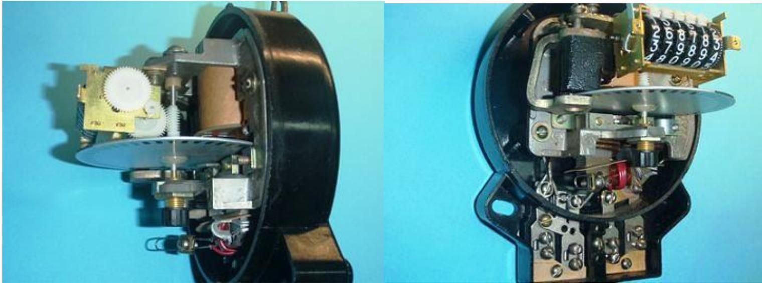
Рис. 2. Устройство индукционного счетчика
