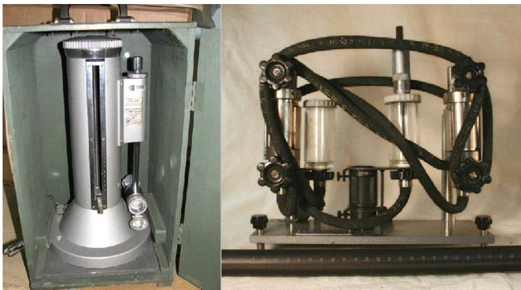
**Фотография прибора МКВ 250(слева) и ППР-2М(справа)**
