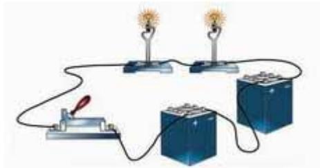
Конец одного проводника соединяется с началом другого
