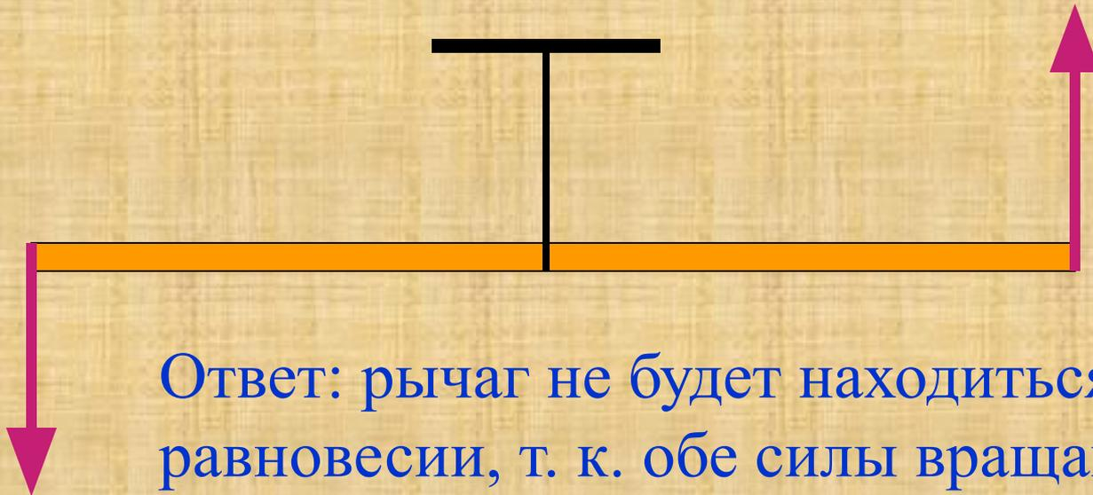
Ответ: рычаг не будет находиться в равновесии, т. к. обе силы вращают его против часовой стрелки.
