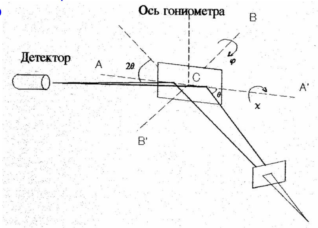
Сканирование в прямом пространстве (вращение образца по  $\chi$  и  $\varphi$ )
