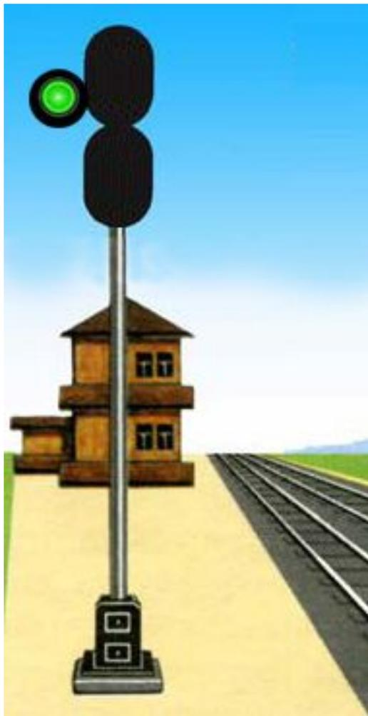
На железнодорожных станциях, где отправление поездов производится с железнодорожных путей, не имеющих достаточной длины, когда голова поезда находится за выходным (маршрутным) светофором, на его обратной стороне устанавливается повторительная головка, сигнализирующая зеленым огнем при открытом выходном (маршрутном) светофоре и свободе впереди двух и более блок-участков
