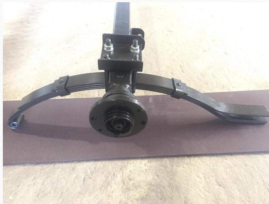
Таким образом устанавливается рессора на раме прицепа. На фото справа показан «каблучок» в который вставляется рессора. Перед установкой обильно смазать смазкой «Литол» внутреннюю поверхность «каблучка», где происходит трение. Продолжаем сборку по аналогичной схеме и с другой стороны, при этом ничего не затягиваем до упора. Только при полной установке подвески производим затяжку болтовых соединений.
