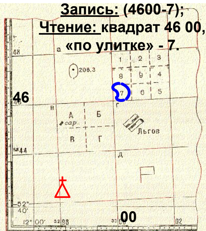
Рис. 13 Целеуказание по квадратам координатной (километровой) сетки
