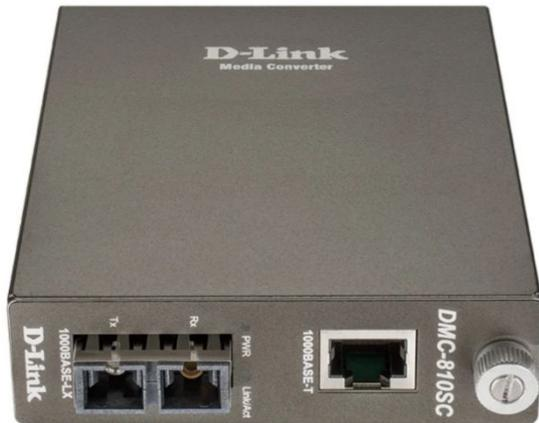
Медиаконвертер DMC-810SC преобразует сигнал стандарта 1000Base-T Gigabit Ethernet по витой паре в сигнал стандарта 1000Base-LX Gigabit Ethernet по одномодовому оптическому кабелю, что позволяет увеличить расстояние соединения (до 10 км) между двумя устройствами. Данный медиаконвертер оснащен одним портом с разъемом RJ-45 для витой пары и одним оптическим портом с разъемом SC.
