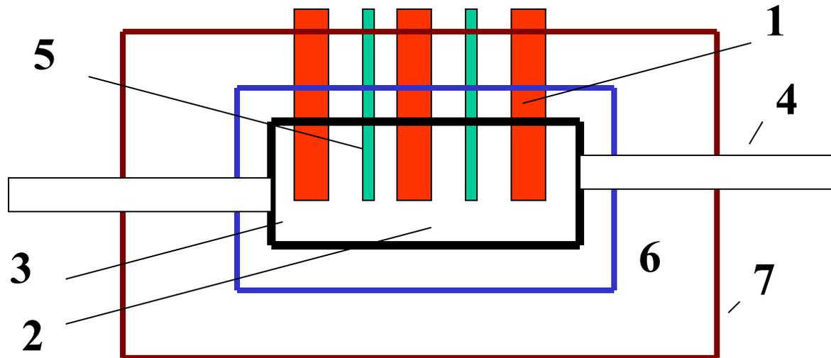
Ядерный реактор **АЭС** содержит ядерное горючее (1)- урановые тепловыделяющие элементы (ТВЛЭы), распределённые в активной зоне (2); замедлитель (3)- графит, беррилий; (4)- тепловую колонку; управляющие стержни (5), поглощающие нейтроны (кадмий, бористая сталь); отражатель нейтронов (6); внешнюю защиту (7).
