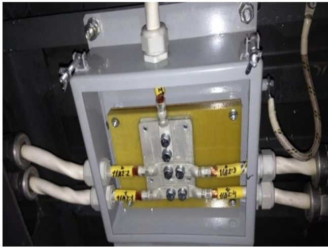
Блок высоковольтный соединительный – БВС. Расположен на вагоне 81-767.
