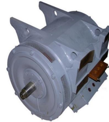
Тяговый асинхронный двигатель. 81-765/766
