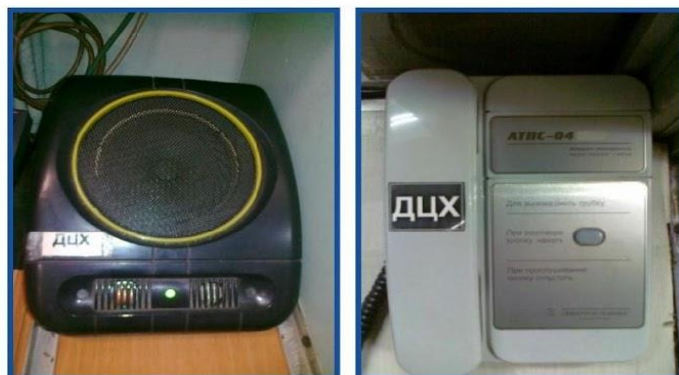
Поездная диспетчерская связь. На блок-посту и в кабине ДСП
