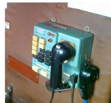
Поездная радиосвязь и микрофон громкоговорящего оповещения в кабине вагона 81-717
