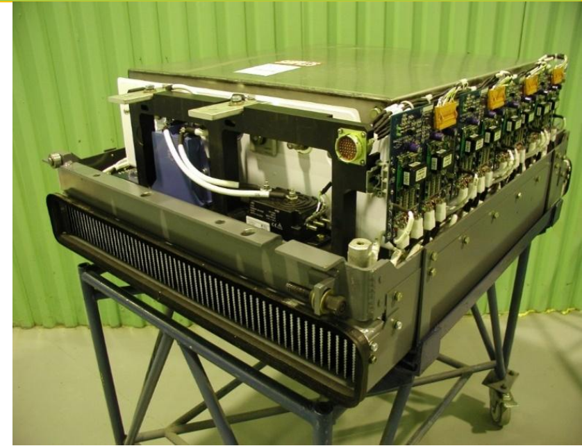
МСИ – модуль силового инвертора.
