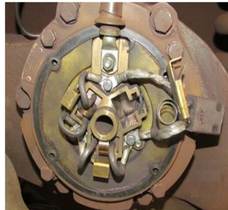
Устройство токоотвода – УТ 02
