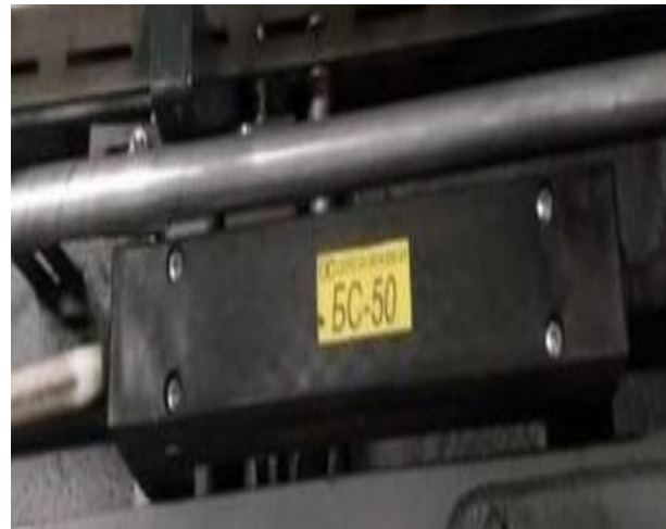
Блок соединительный БС-50. Расположен на вагоне 81-767.
