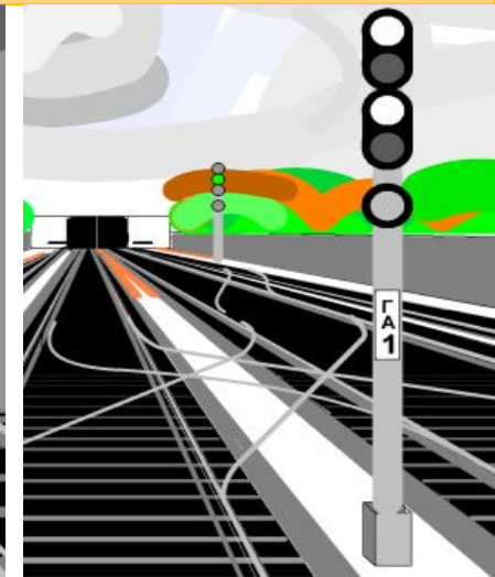
Разрешается производить маневры на парковых путях до следующего светофора в направлении главных путей.
