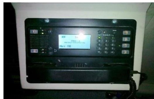
Поездная радиосвязь в кабине вагона 81-760
