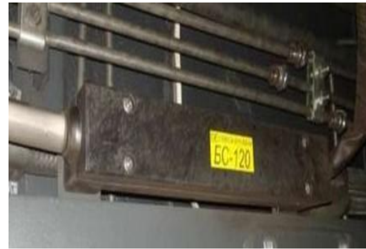
Блок соединительный БС-120. Расположен на вагоне 81-765/766.
