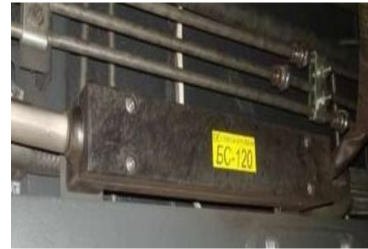
Блок соединительный БС-120. Расположен на вагоне 81-765/766.
