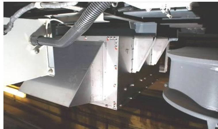
Короб тормозного резистора Расположены у тележки, вагонов 81-765/766.
