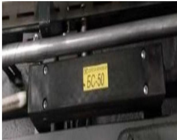
Блок соединительный БС-50. Расположен на вагоне 81-767.
