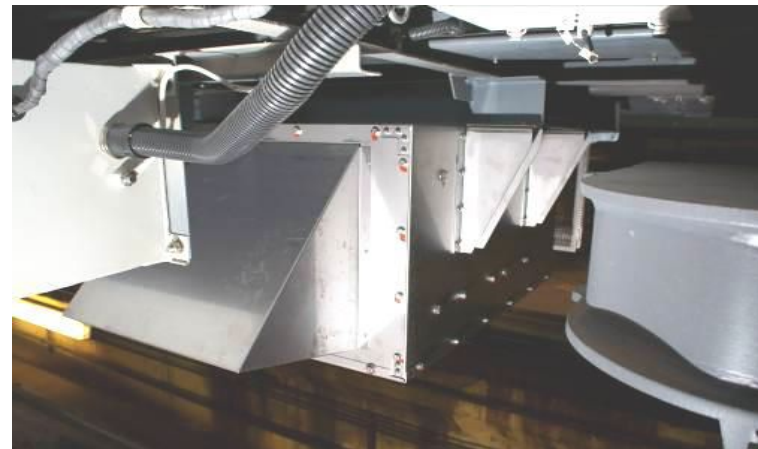
Короб тормозного резистора Расположены у тележки, вагонов 81-765/766.
