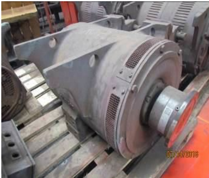
ТЭД без коллекторный асинхронный 3 фазный переменного тока
