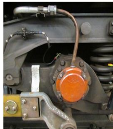
Устройство токоотвода – УТ 02
