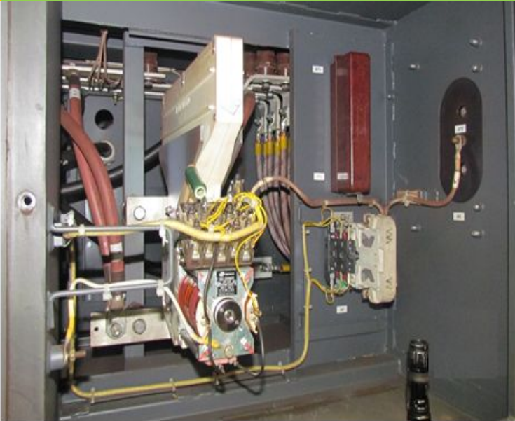
Линейный и зарядный контактор. Расположены в 1 отсеке КТИ.
