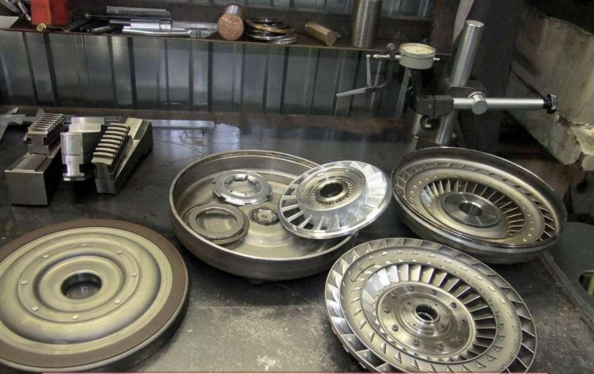
Гидротрансформатор перед сборкой.
