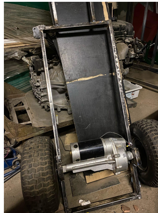
Изображение 4 – Пример крепления заднего двигателя в вертикальном положении
