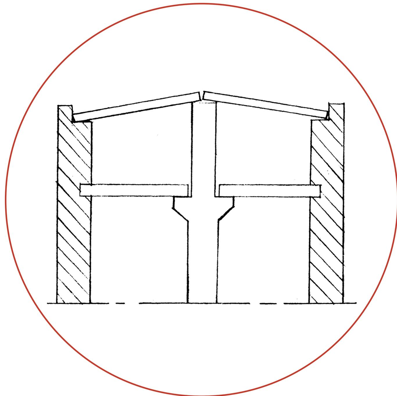
Конструктивные схемы зданий с неполным каркасом могут быть:
