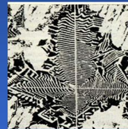
Скелетная эвтектика \gamma(\text{Fe}) + (\text{W, Fe})_6\text{C}
