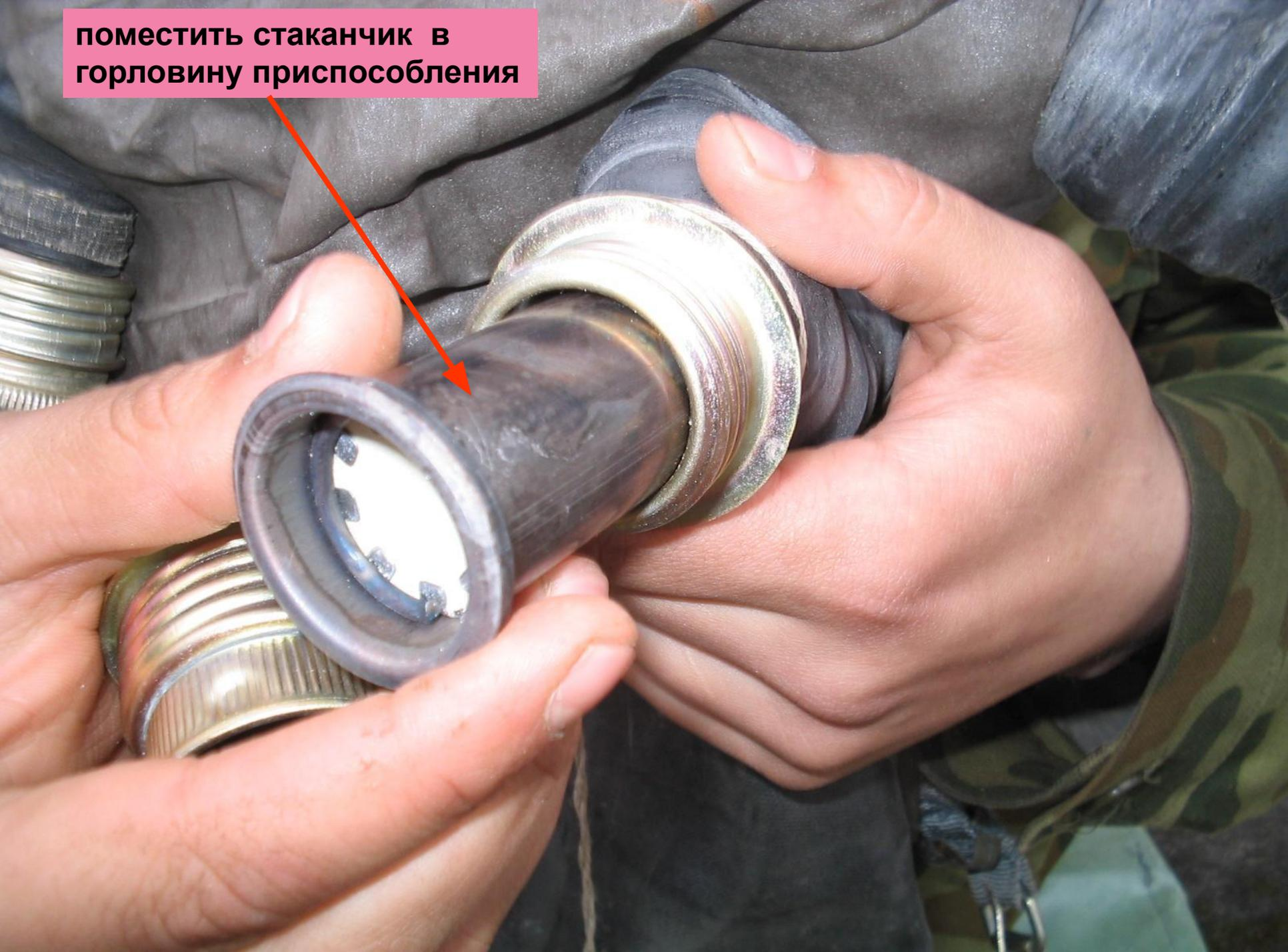
**плотно завернуть гайку с венчиком на корпус приспособления**
