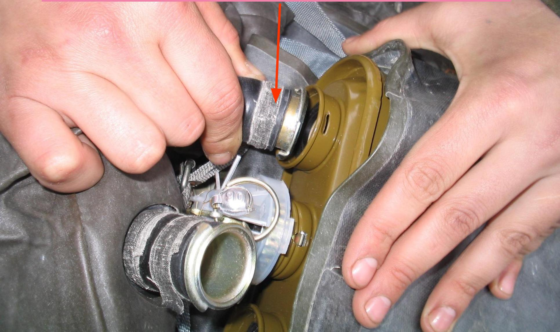
**повернуть второй ниппель мешка на четверть оборота по часовой стрелке, вставит его во второе гнездо патрона и повернуть против часовой стрелки до упора**
