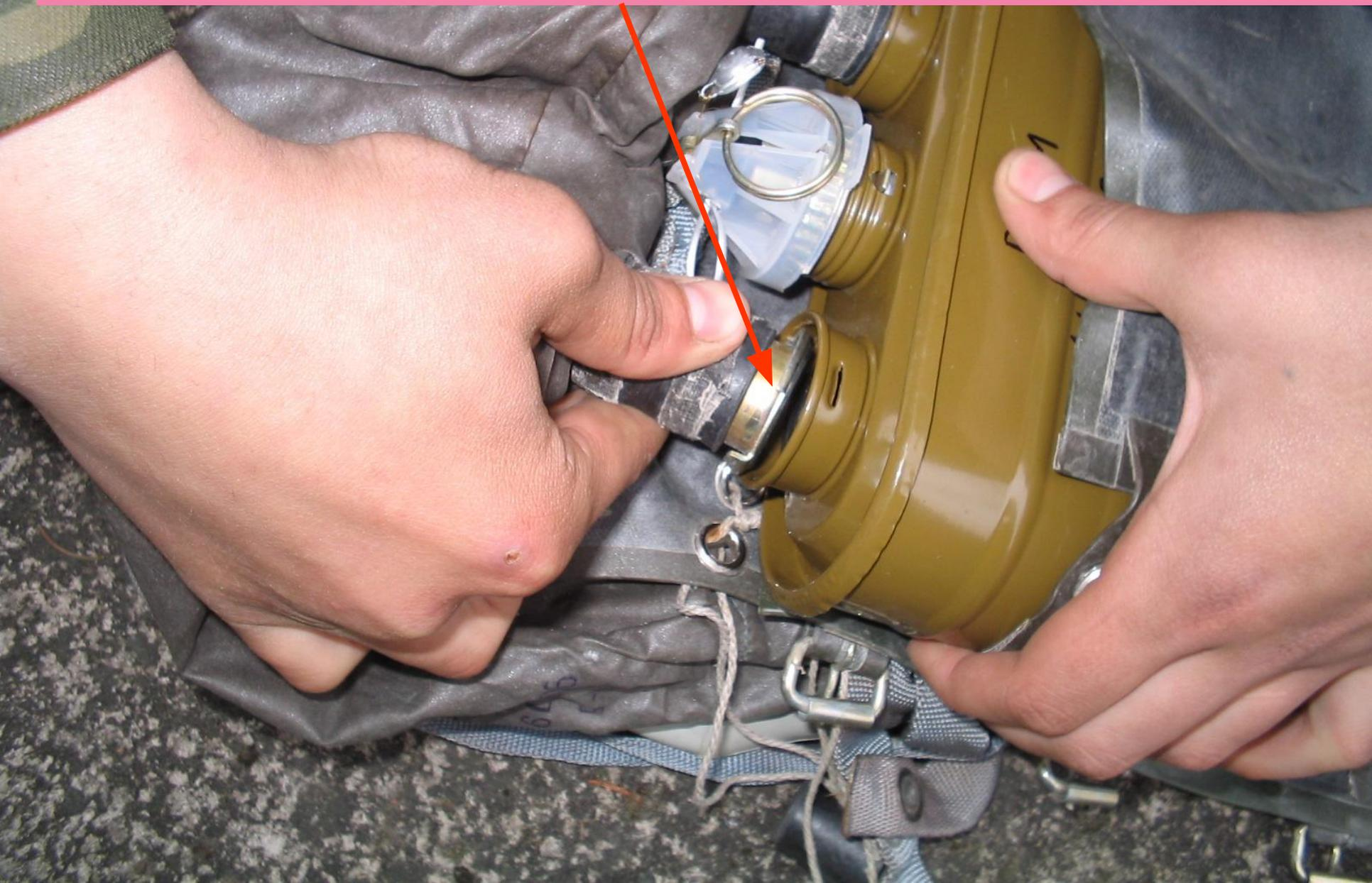
**вложить патрон в карман нагрудника и закрепить ремешками; при правильном присоединении патрона кольцо пускового устройства должно находиться со стороны передней стенки (клапана) кармана.**
