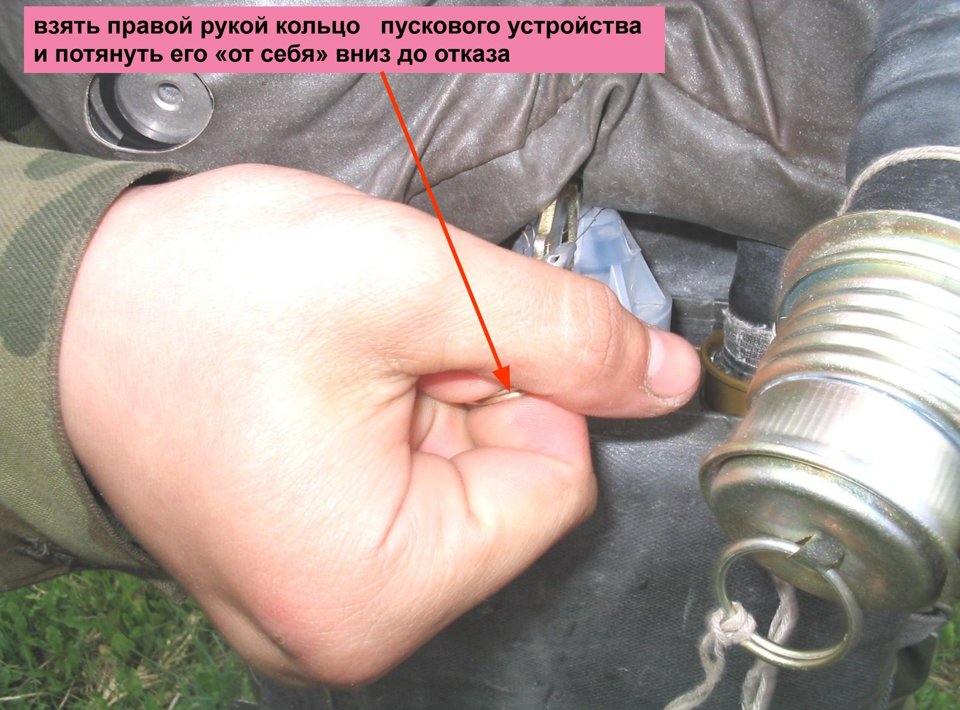
**Проверить правильность включения пускового устройства.
