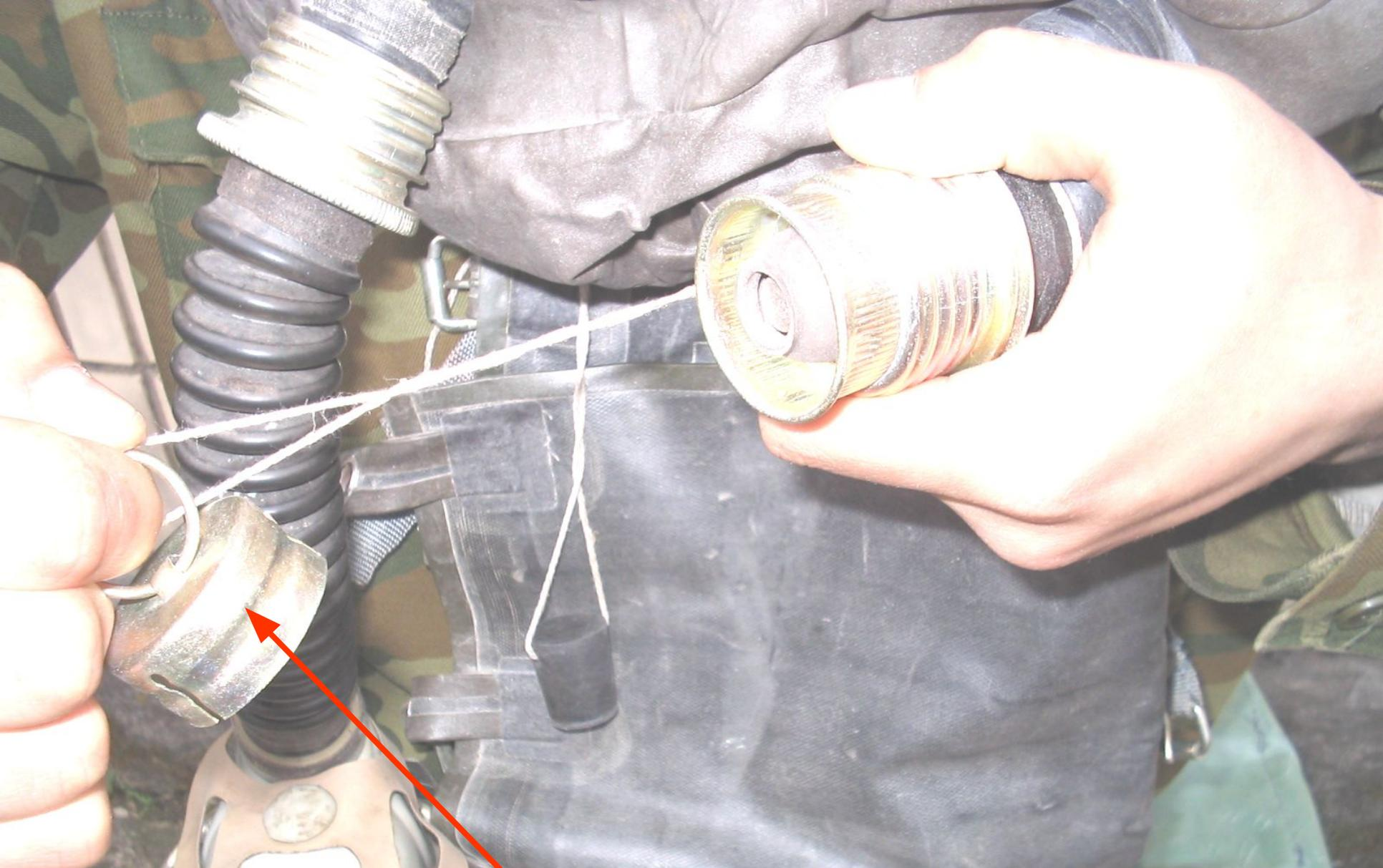
**извлечь из приспособления предохранительный колпачок с кольцом;**
