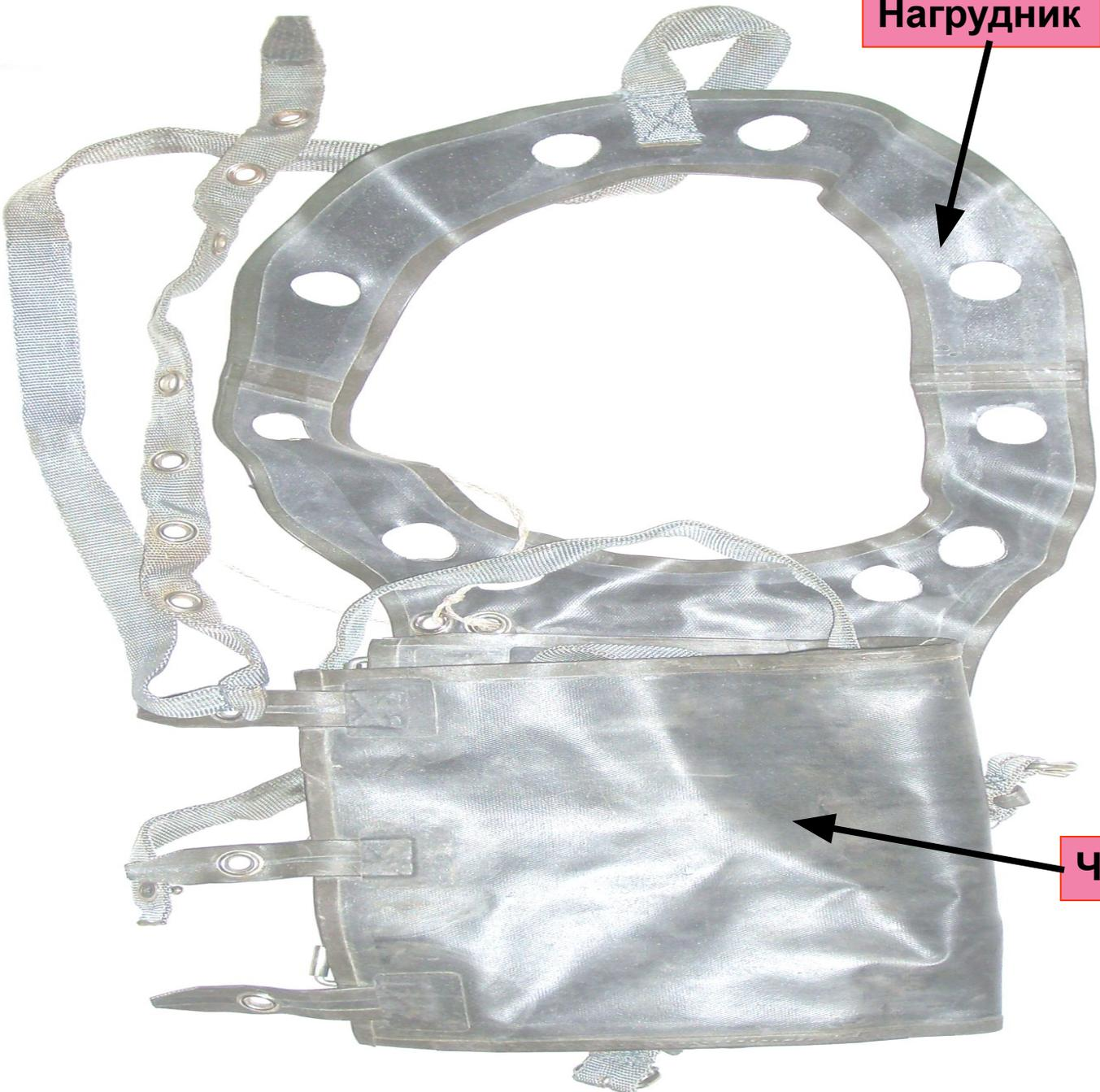
**Лицевая часть ШИП-М служит для изоляции органов дыхания и зрения от окружающей среды, направления выдыхаемой газовой смеси в регенеративный патрон, подведения очищенной от углекислого газа и водяных паров и обогащенной кислородом газовой смеси к органам дыхания.**
