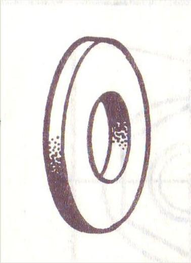
Изделие сравнительно малой толщины, не имеющее резьбы, закладываемое под гайку или головку болта.
