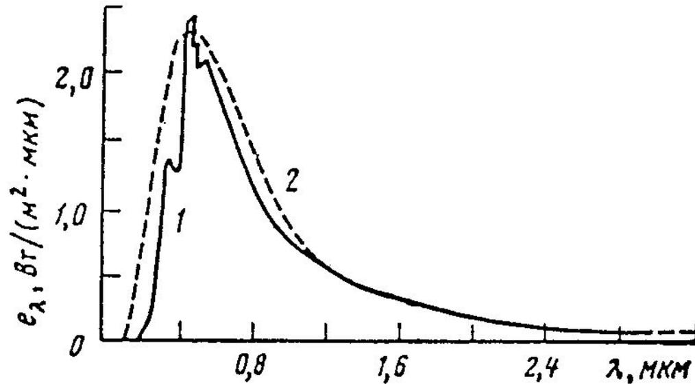
Рис. 1. (1) Спектр излучения Солнца и (2) спектр излучения абсолютно черного тела при температуре  $T_C \sim 5800 \text{ К}$ .
