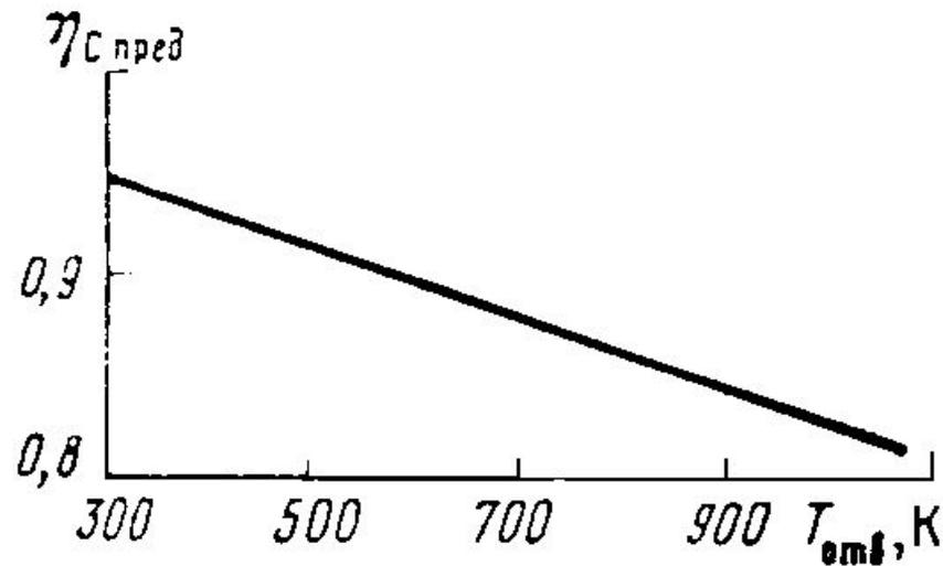
Рис. 4. Зависимость предельного теоретического кпд преобразователей солнечной энергии в космосе от температуры ТОА ( $T_{\text{отв}}$ )
