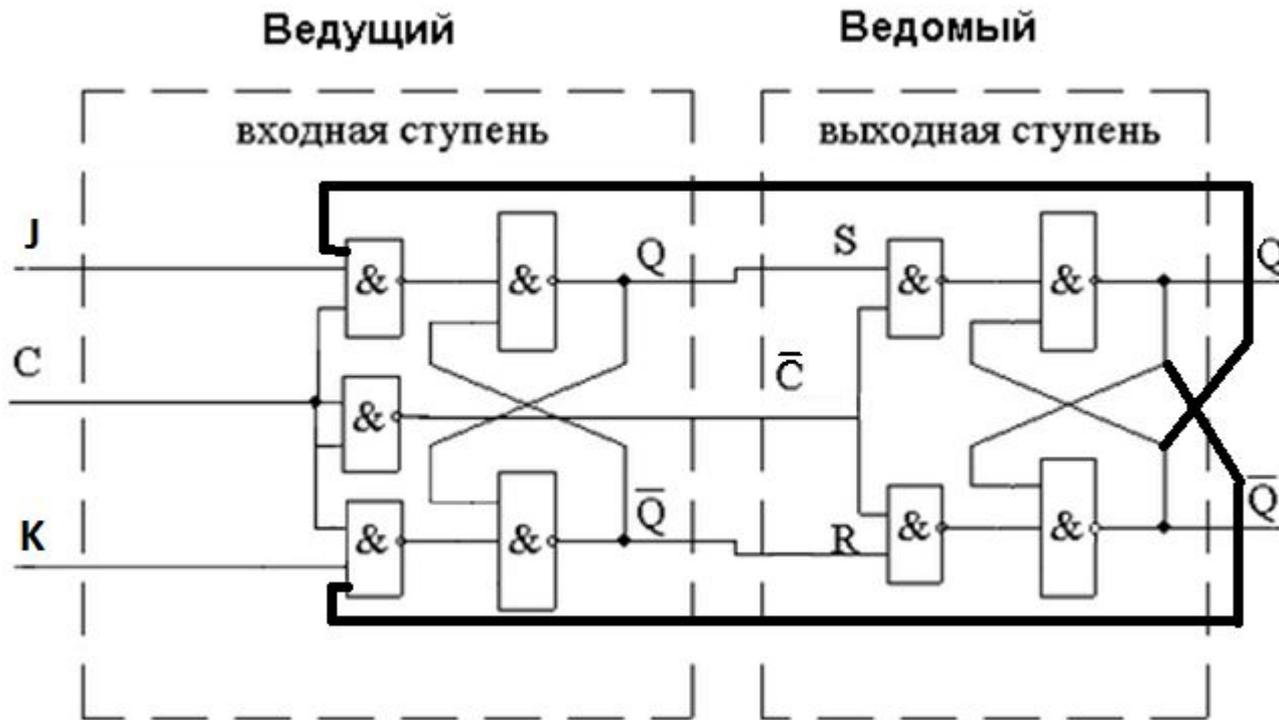
При  $J=K=1$  состояние триггера изменяется при каждом отрицательном фронте тактового импульса.
