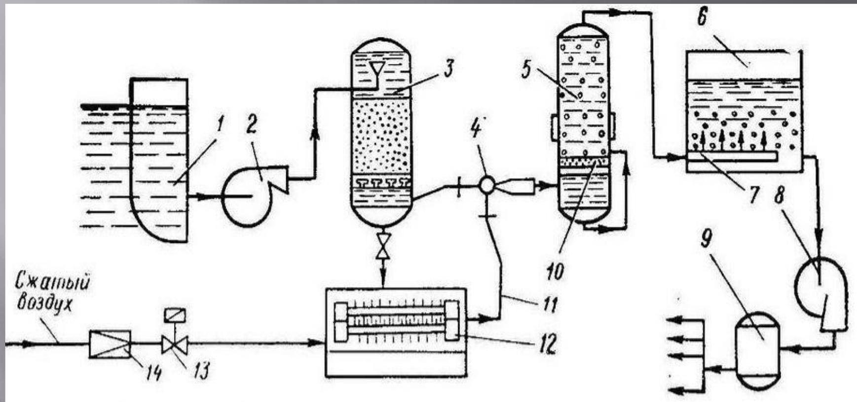
1 - ящик заборной воды; 2 - электронасосы; 3 - песочный фильтр; 4 - эжектор-смеситель; 5 - контактная колонна; 6 - накопительная цистерна; 7 - дренажный трубопровод; 8 - электронасос; 9 - пневмоцистерна; 10 - распылитель; 11 - трубопровод; 12 - озонаторный агрегат; 13 - электромагнитный клапан; 14 - редукционный клапан.
