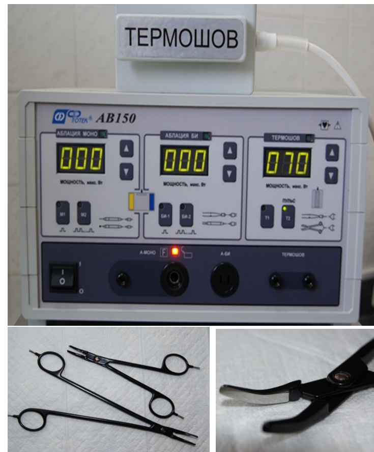
Фото. Инструмент покрыт изолирующим напылением. Рабочие бранши - отполированы.
