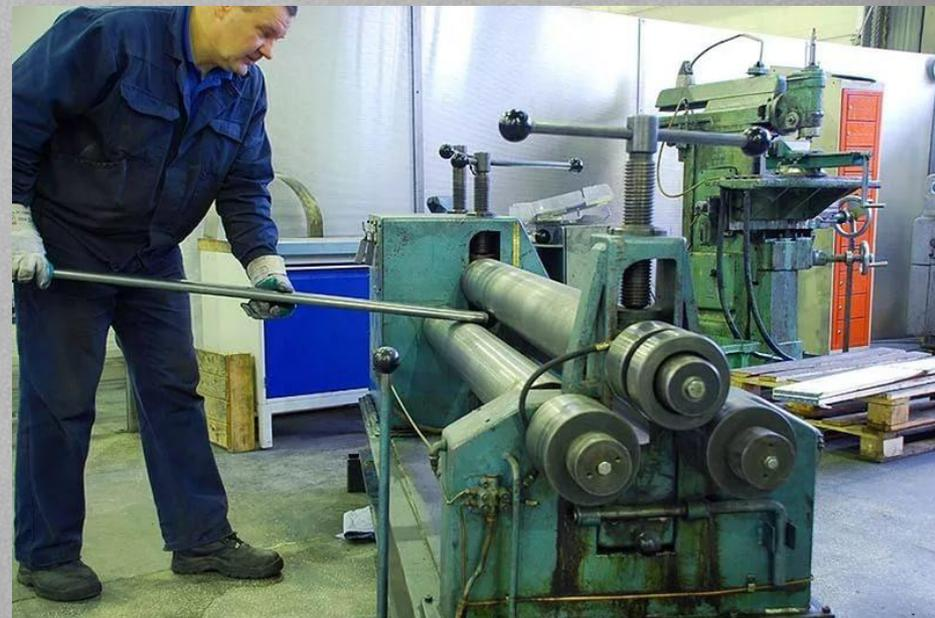
Изготовлением изделий из тонколистового металла на предприятиях занимаются *жестящики*. Они должны знать устройство различных станков и приспособлений для обработки листового металла и уметь работать на них, применяя различные инструменты.
