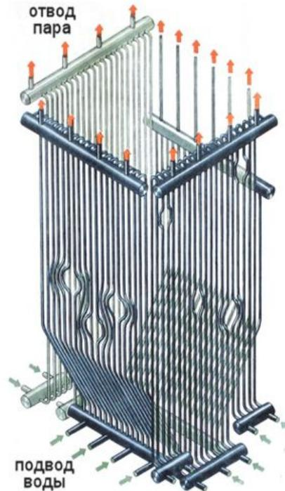
✓ Поверхности нагрева называют **конвективными**, если теплота от продуктов сгорания топлива передается рабочему телу конвекцией (перенос теплоты потоками греющих и нагреваемых сред)
