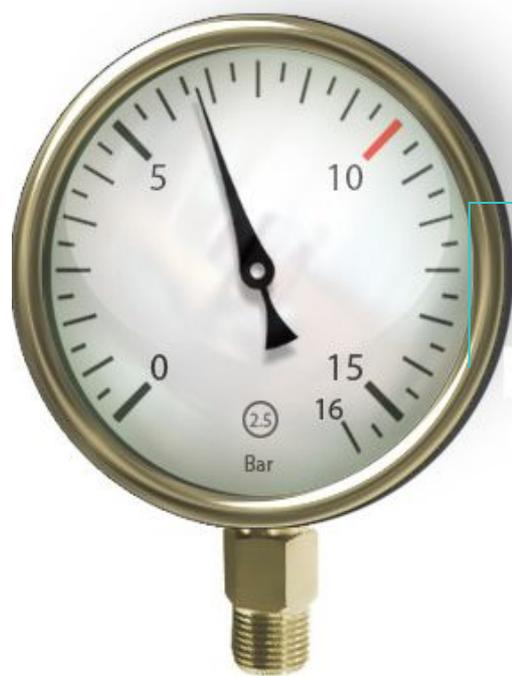
Вместо красной черты может быть прикреплена к корпусу манометра путем пайки металлическая пластинка, окрашенная в красный цвет и плотно прилегающая к стеклу манометра. Наносить красную черту непосредственно на стекло манометра не разрешается
